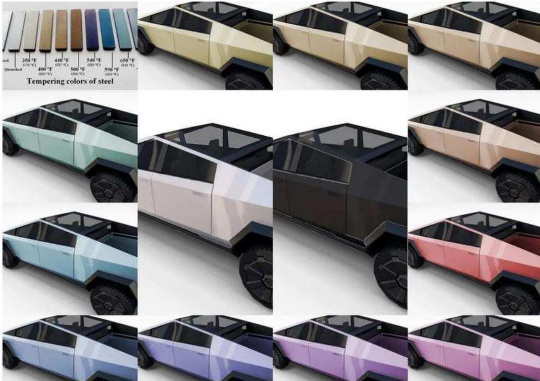
图10 冷轧钢回火实现不同车身颜色
